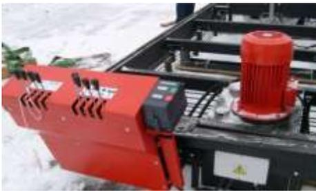
Пульт управления гидроагрегатами и гидростанция
