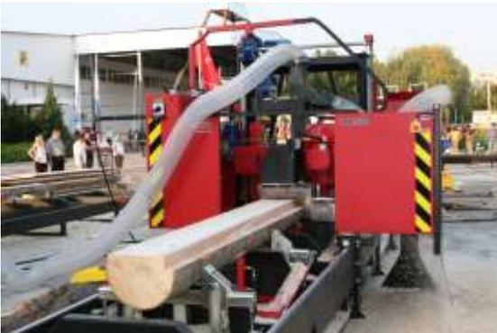
Компания "StrojCAD" предлагает однодисковый лесопильный станок для радиального раскроя брёвен угловым способом с использованием механизма автоматического поворота пильного блока. Это позволяет значительно снизить расходы на распиловку за счёт экономии электроэнергии и расходных материалов. Конструкция станка позволяет получать пиломатериал с высочайшей геометрической точностью и идеальным качеством поверхности.
